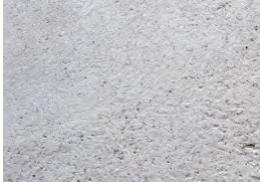
Oberfläche bearbeitet mit Kugelstrahl-Verfahren
